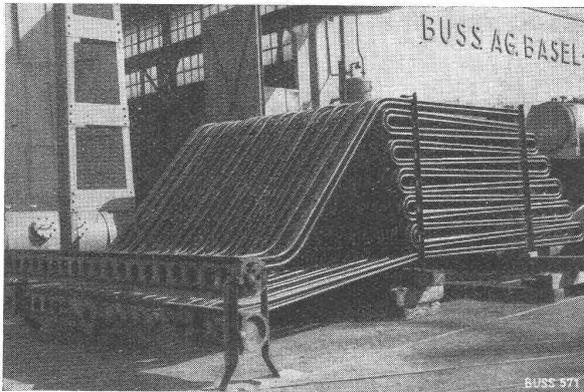
Ueberhitzer für einen Steilrohrkessel 500 m<sup>2</sup>, 34 Atü, 425° C Dampf-Temperatur, Rohrschlangen in Speziallegierung
