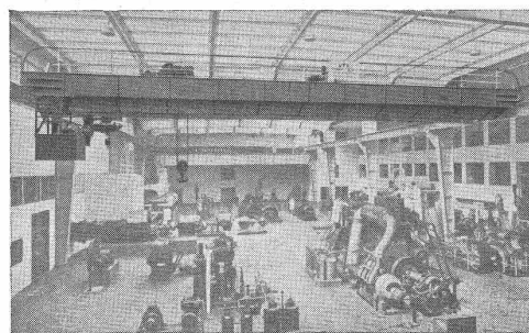
Maschinen-Laboratorium der E.T.H. Zürich. Geliefert: 3-Motoren-Lautkran für 10 T. mit Hilfskatze 2 T. Tragkraft.
