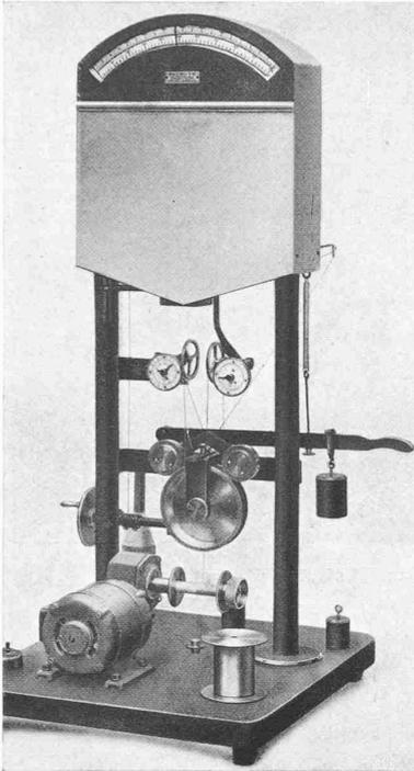
Abb. 1. Spannungs- und Dehnungsmesser mit laufendem Werkstoff
