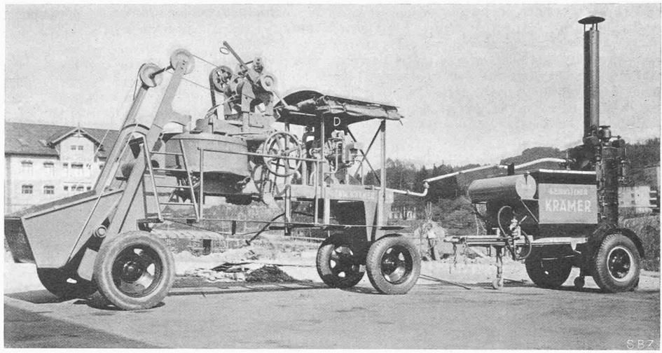
Abb. 4. Heissmischer mit SLM-Kleindampfmaschine (D) und Dampfkessel, für Salvia-Strassenbeläge
