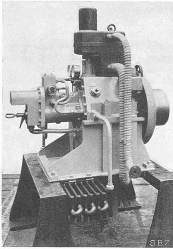
Abb. 3. SLM-Kleindampfmaschine
