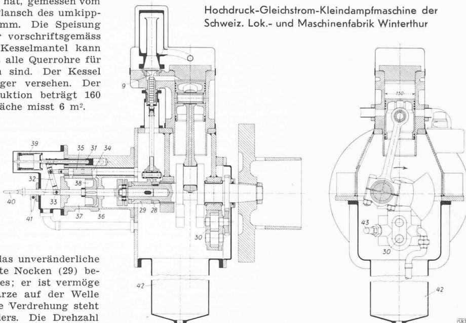
Abb. 2. Längs- und Querschnitt der Kleindampfmaschine. — 1:15
