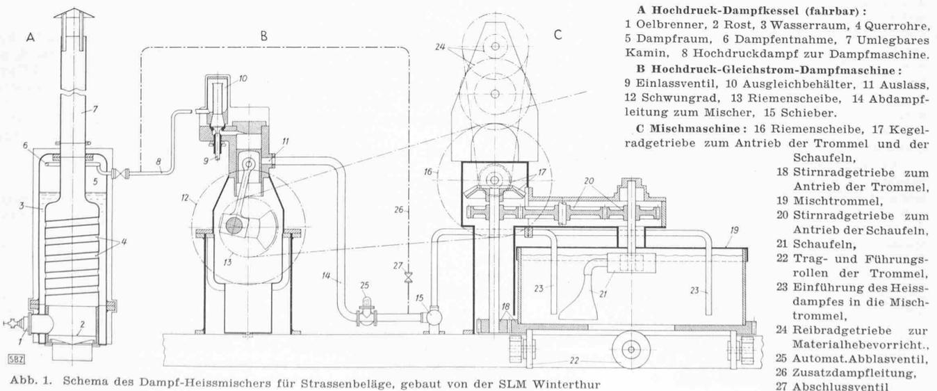
Abb. 1. Schema des Dampf-Heissmischers für Strassenbeläge, gebaut von der SLM Winterthur
