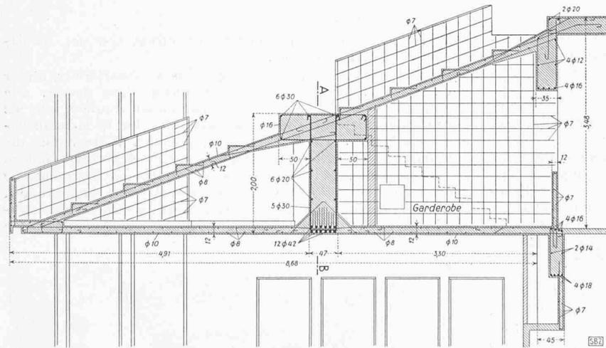
Abb. 19. Armierungsplan der über den I-Träger vorkragenden Empore. — 1 : 80
