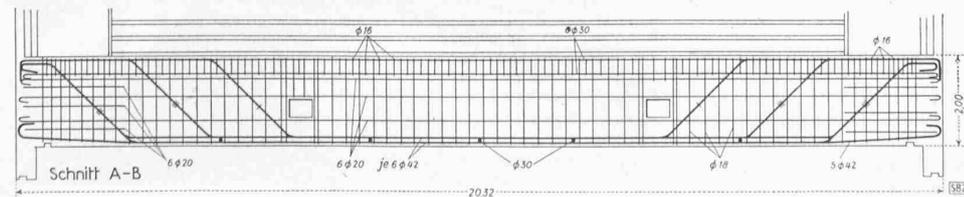
Abb. 20. Armierungsplan des T-förmigen Emporenträgers von 20 m Stützweite. — 1 : 150
