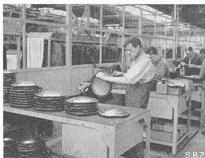
Abb. 3. Bearbeiten der Deckel für die Entwicklerkammern
