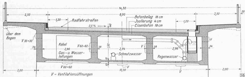
Abb. 3. Querschnitt des Fahrbahn-Kasträgers. — Masstab 1 : 120
