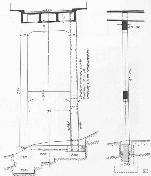
Abb. 5. Zweistöckiger Querrahmen der Anschlussviadukte. — 1:300
