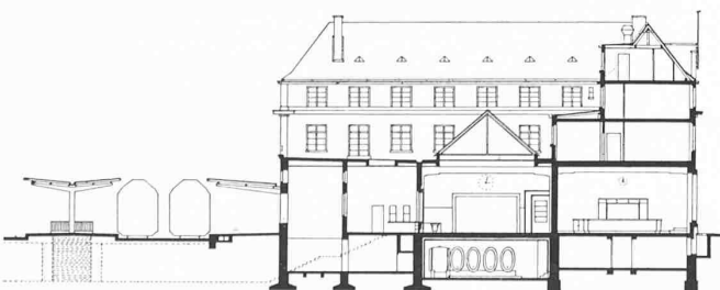
Fig. 14. Coupe du Bâtiment aux voyageurs 1 : 600
