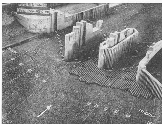
Abb. 6. Mit teilweiser Sohlenabdeckung
