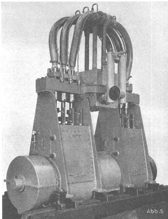
tion sind folgende: Patentierte Steuerung mit Druckknopfschalter mit höchster Betriebssicherheit; automatische, doppelwirkende Backenbremse, durch Servo-Motor betätigt, ohne Bremsmagnet mit dessen Nachteilen; zwangsläufige Seilführung mit Seilbewicklungs-vorrichtung; Feingang 1:10 mit durch Motor betätigter Kupplung.
