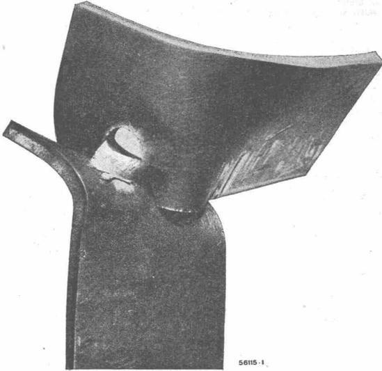
ZerreiBversuch an einer Punktschweissung
