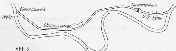
Abb. 2 Maschinenhaus zwischen Ober- und Unterwasserkanal (Kraftwerke Olten-Gösgen und Hagneck)
