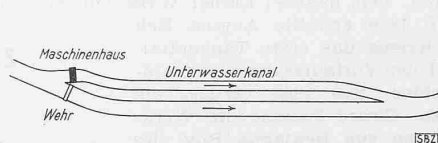
Abb. 3 Maschinenhaus bei der Wasserentnahme, Oberwasserkanal sehr kurz. (Kraftwerk Rapperswil-Auenstein)
