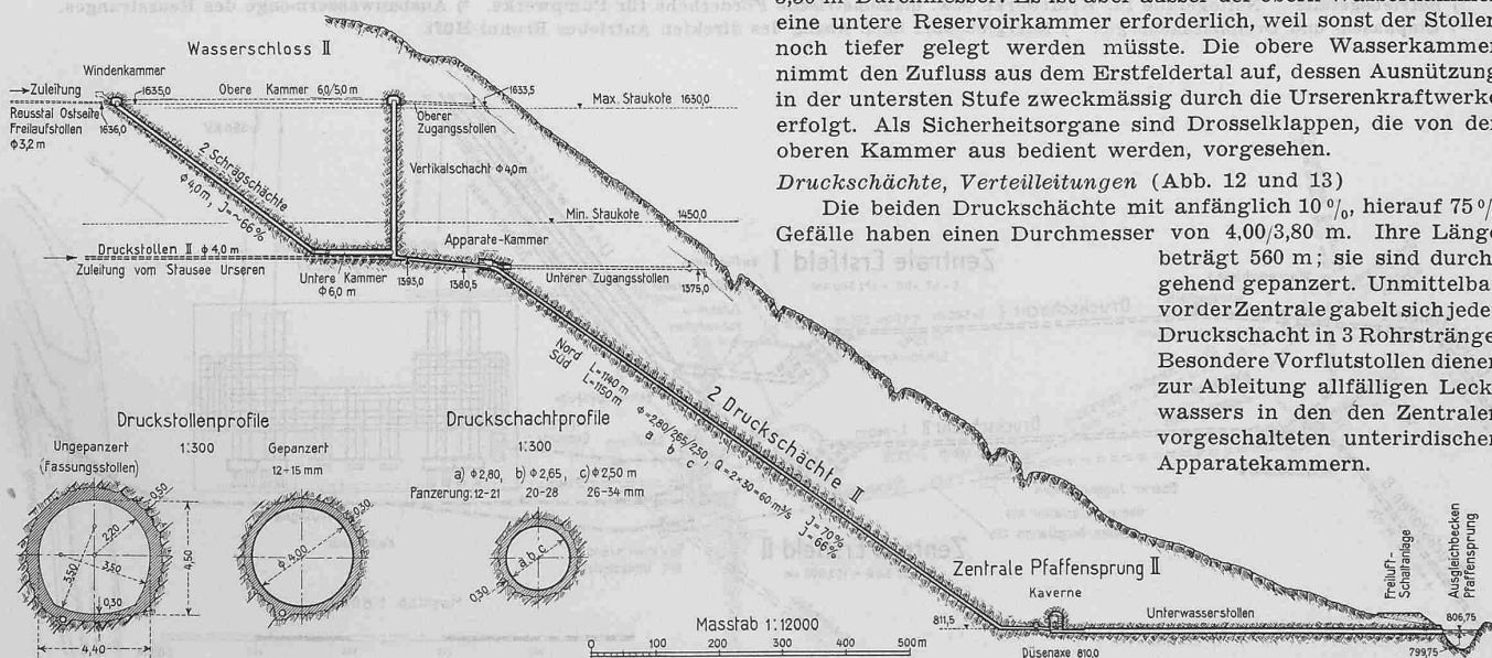
Abb. 10. Hauptkraftwerk Pfaffensprung II, Längenprofil Wasserschloss-Zentrale 1:12000 und Stollenprofile 1:300
