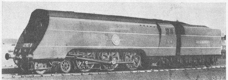
Bild 1. 2C1-Lokomotive «Merchant Navy» der Southern Railway
