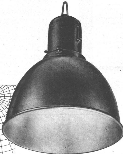
Dieser ALUMINIUM-LICHT-Reflektor ist die neuzeitliche Armatur für Betriebsbeleuchtungen aller Art. Innen matt alzaciert, ergibt er bei entsprechender Aufhängehöhe ein blendungsfreies Licht. Da er sowohl auf Breit- als auch auf Tiefstrahlung eingestellt werden kann, eignet er sich gleichermaßen für Allgemein- wie für Arbeitsplatzbeleuchtung. Er ist in Größen von 14,5 bis 41,5 cm Durchmesser und für Glühlampen von 40 bis 2000 Dlm lieferbar.
