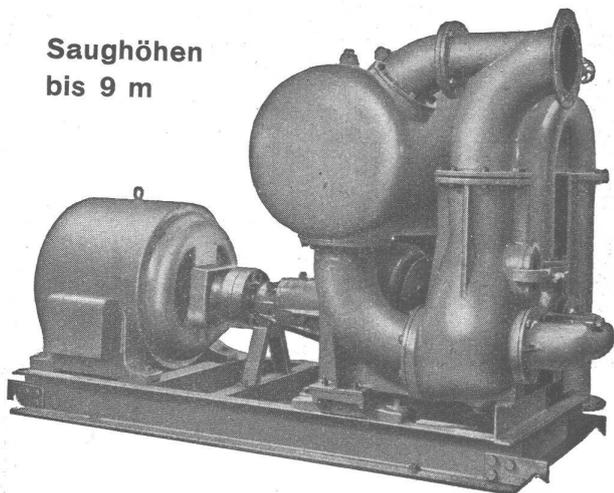
Leistungen 1 bis 500 Liter/Sek. Kein Bodenventil. Keine Klappe im Saugstutzen. Keine Hilfs-Vakuum-Pumpe. Jederzeitiges automatisches Ansaugen auch nach Luft-eintritt im Saugrohr. Keine reibenden, sich abnützenden Dichtungsflächen, daher unempfindlich, gegen Sand, Schlamm und Kies.
