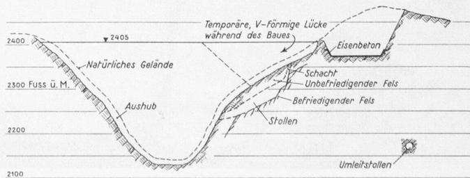
Bild 3. Längsschnitt durch die Dammkrone, 1: 3500
