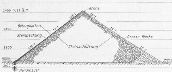
Bild 2. Querschnitt des Dammes, 1: 3500
