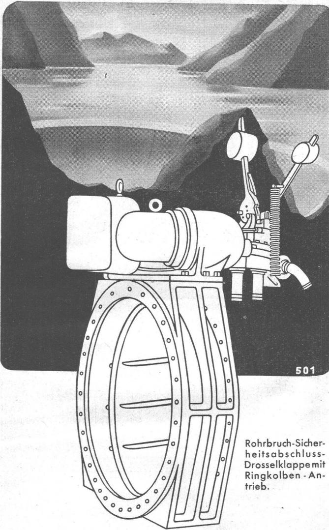
Rohrbruch-Sicherheitsabschluss-Drosselklappe mit Ringkolben-Antrieb.
