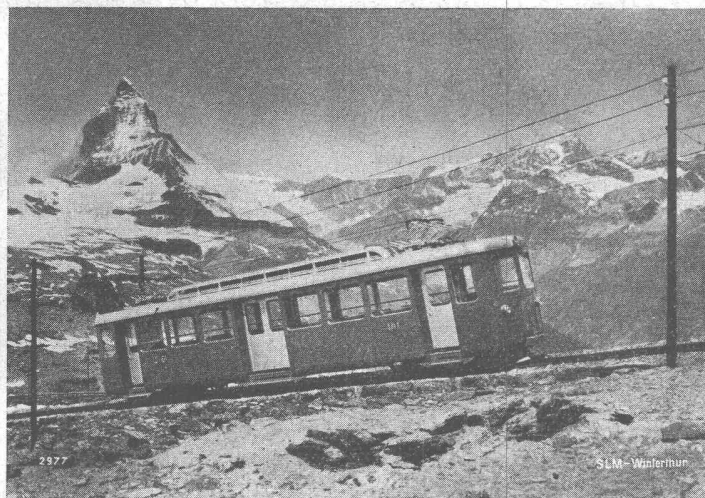
Elektrischer Zahnradtriebwagen der Gornergrat-Bahn
