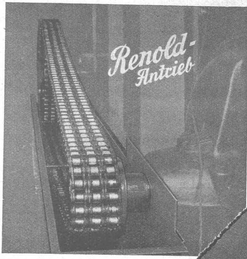
eines „Holländers“, 150 PS, bei 435/1116 T. p. M.
