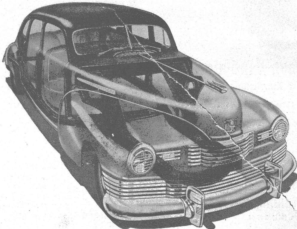
... weil sie wissen, dass die Vereinigung von Chassis und Karosserie zu einer vollkommen verschweissten Einheit eine wesentlich leichtere, widerstandsfähigere und um über 60 % verwindungsfestere Konstruktion ergibt, die zudem geräumiger ist und durch den Wegfall von Bolzen und Schrauben dauernd geräuschlos bleibt.
