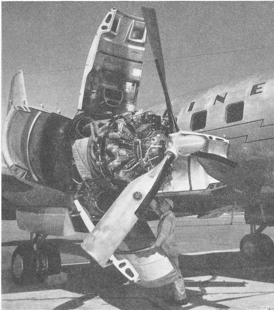
Bild 3. Motorgondel mit aufgeklappter Verschaltung
