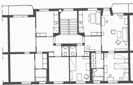
Bild 4. Schwedischer elastischer Grundriss mit Einzelzimmer, das wahlweise als Separatzimmer verwendet oder zur Wohnung geschlagen werden kann
