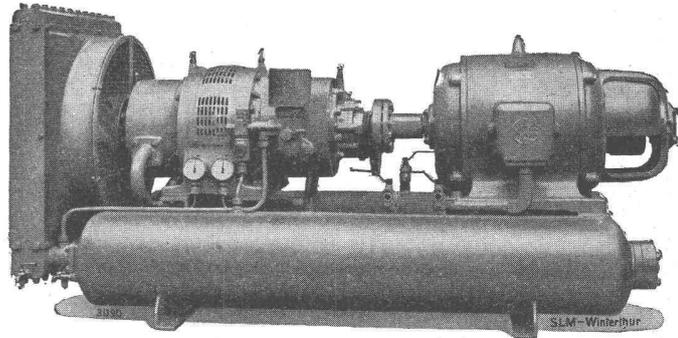
Luftgekühlter SLM-Baukompressor, 3,5 m<sup>3</sup>/min,
