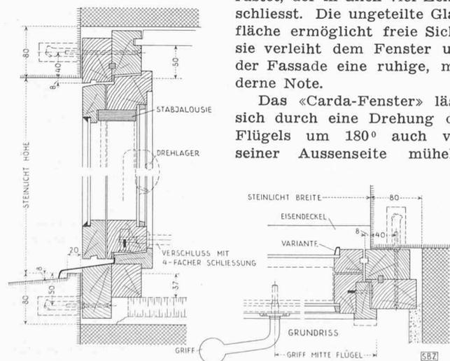
Bild 4. Carda-Fenster, konstruktive Einzelheiten 1:8
