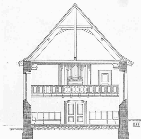
Bild 2. Renoviertes Kirchlein Fluntern, Querschnitt 1: 200
