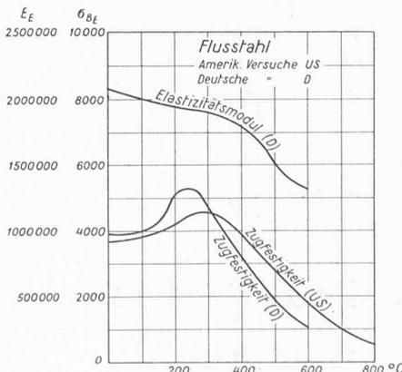
Bild 1a. Flusstahl
