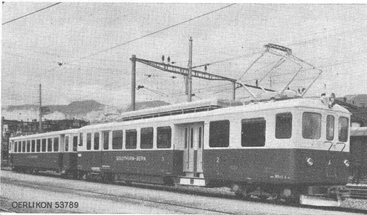
Neue Zugskomposition der Solothurn-Bern-Bahn, bestehend aus Motorwagen BCFe  $\frac{4}{4}$ , Stundenleistung 720 PS, Geschwindigkeit 65 km/h, 1200 V Gleichstrom, mit Steuerwagen für Pendelbetrieb. — OERLIKON lieferte die elektrische Ausrüstung für 6 Motorwagen und 3 Steuerwagen.
