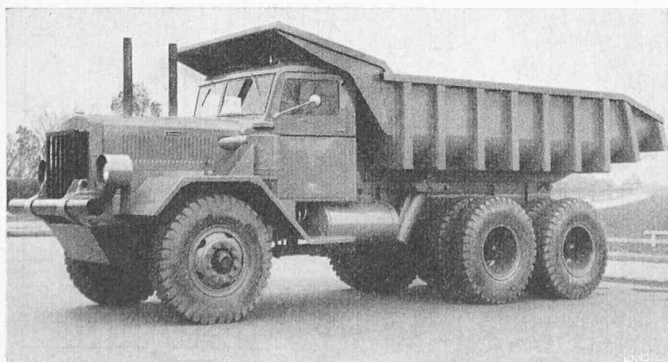
Bild 6. Amerikanischer Erzwagen für 20 t Nutzlast
