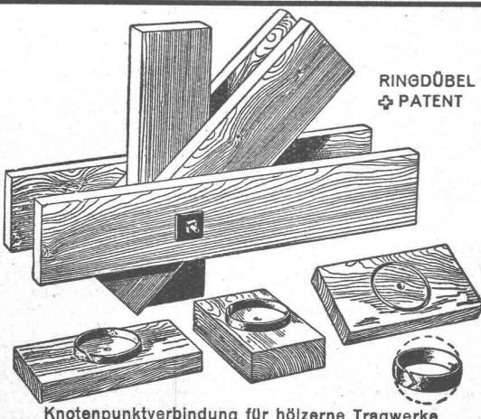
Knotenpunktverbindung für hölzerne Tragwerke
