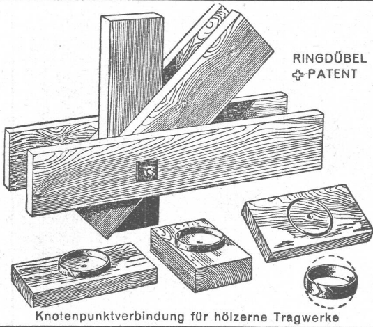
Knotenpunktverbindung für hölzerne Tragwerke
