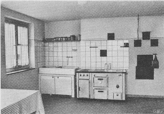
Bild 7. Schüttstein, Holzvergaser- und elektrischer Herd mit Warmwasserboiler kombiniert, in praktischer, gut belichteter Anordnung erleichtern die Arbeit der Hausfrau
