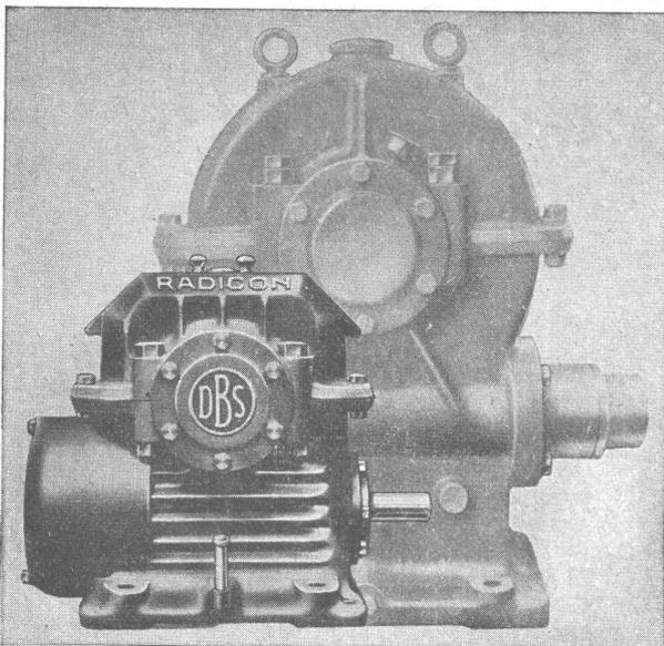
Sonderkühlung, Oelumlaufschmierung für Getriebe und Lager, David Brown Schneckenform, hohe Leistung und Wirkungsgrad bei kleinsten Abmessungen, niedrigerer Preis als für gewöhnliche Schneckengetriebe gleicher Leistung, zuverlässig, geräuschlos.
