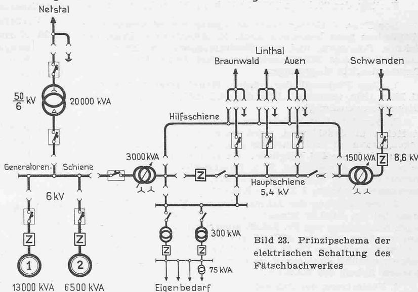
Bild 28. Prinzipschema der elektrischen Schaltung des Fätschbachwerkes
