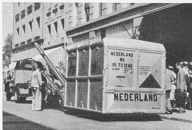
Bild 6. Die Behälter können auch auf Spezial-Strassenfahrzeuge übergeladen und von diesen beim Empfänger auf den Boden abgesetzt werden.
