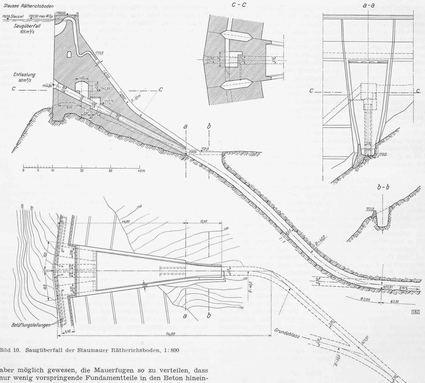
Bild 10. Saugüberfall der Staumauer Räterichsboden, 1:800
