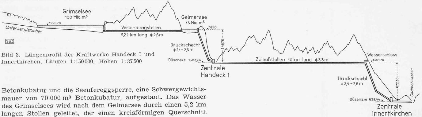
Bild 3. Längsprofil der Kraftwerke Handeck I und Innertkirchen. Längen 1:150 000, Höhen 1:37 500
