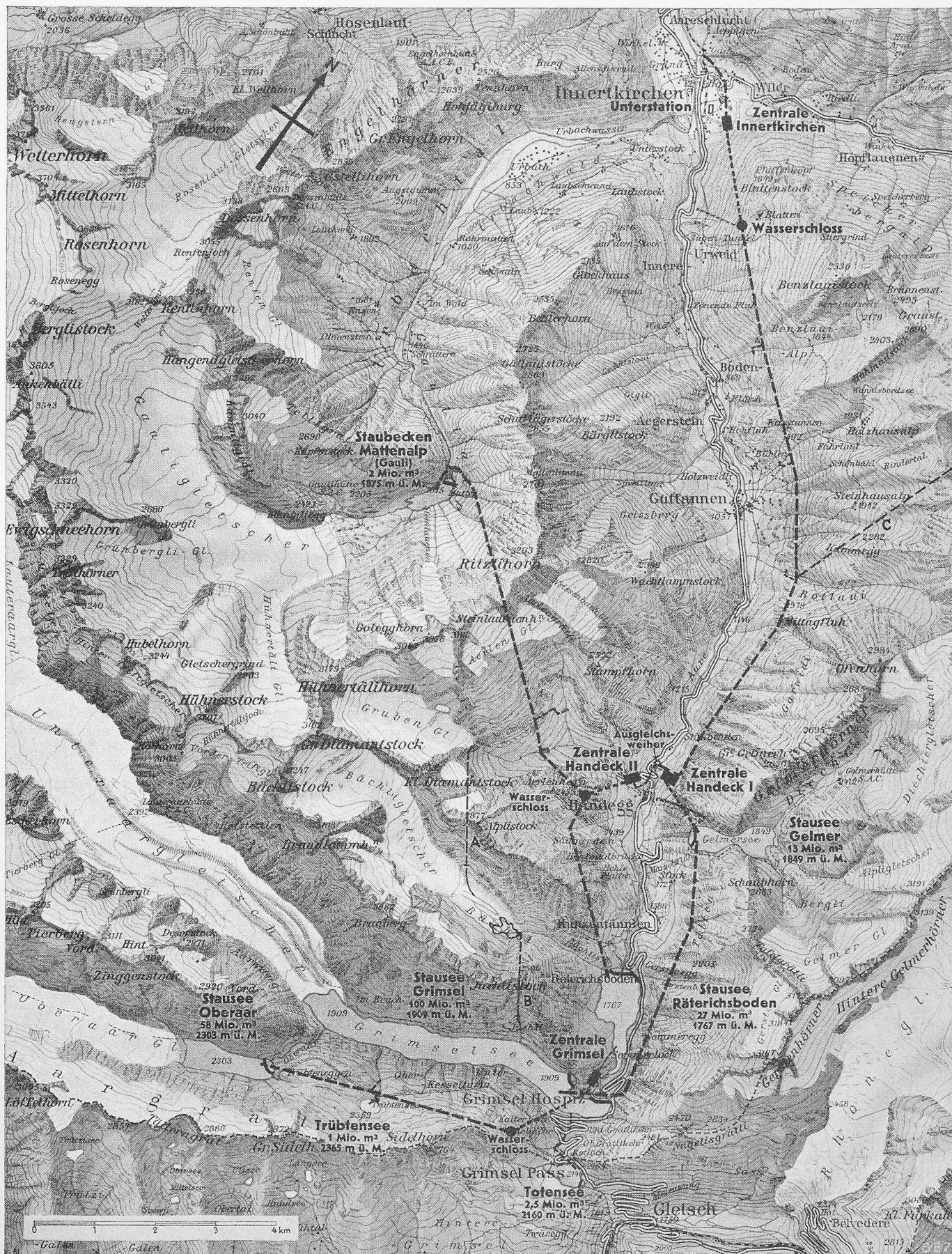
Bild 1. Wasserkraftanlagen im Oberhasli, Uebersichtskarte 1:85 000, reproduziert mit Bewilligung PTT, KWO und Kümmerly & Frey, Bern. A Ueberleitung Grubenbach, B Ueberleitung Bächlisbach, C Zuleitung der Trift- und Gadmenwasser
