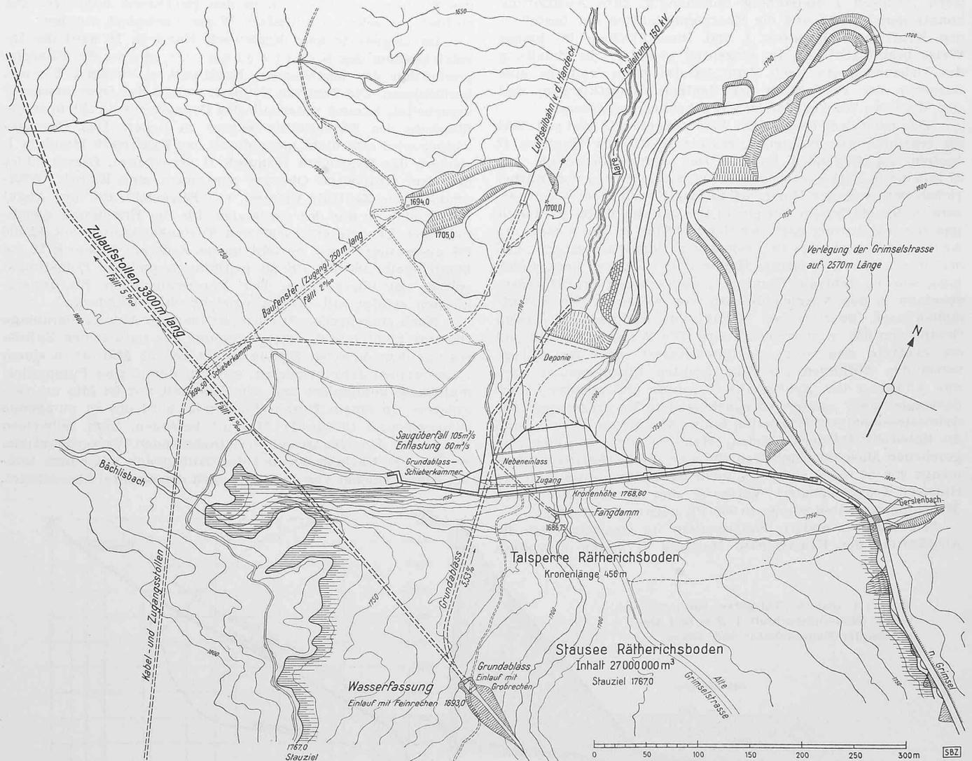
Bild 7. Anlagen der Talsperre Räterichsboden, Plan 1:5000
