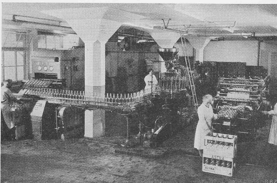
Bild 30. Links Flaschenreinigungsmaschine, daneben Abfüllmaschine, rechts Verpackung
