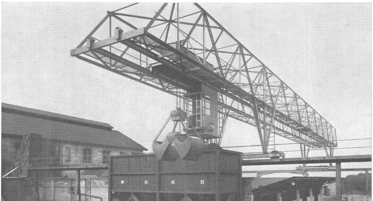
Verladebrücke in Schweisskonstruktion 2,5 t Tragkraft, 46 m Länge
