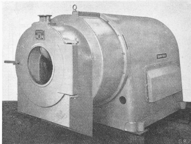
Bild 11. Schubzentrifuge. Motoren, Antriebe, Steuerorgane usw. sind in den Stator eingebaut. Ausstossleistung rd. 4 t/h.
