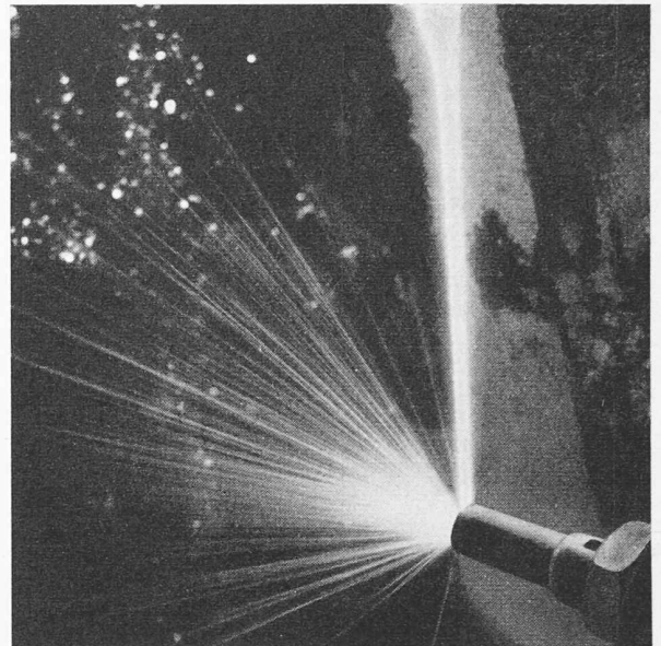
Bild 1. Zerfasern der flüssigen Steinmasse mit Druckluft
