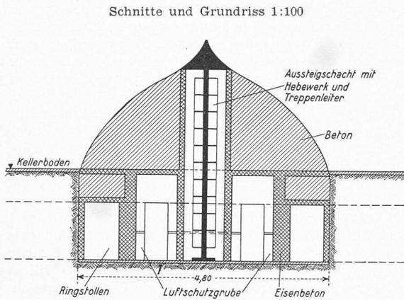
Bild 3. Innenanlage mit  $\frac{3}{4}$  Vollbetonglocke, verbreiterter Luftschutzgrube, Ein- und Ausstiegsschacht, Ringstollen
