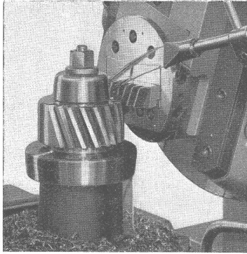
Schneiden eines Schraubenrades auf MAAG-Zahnradhobelmaschine
