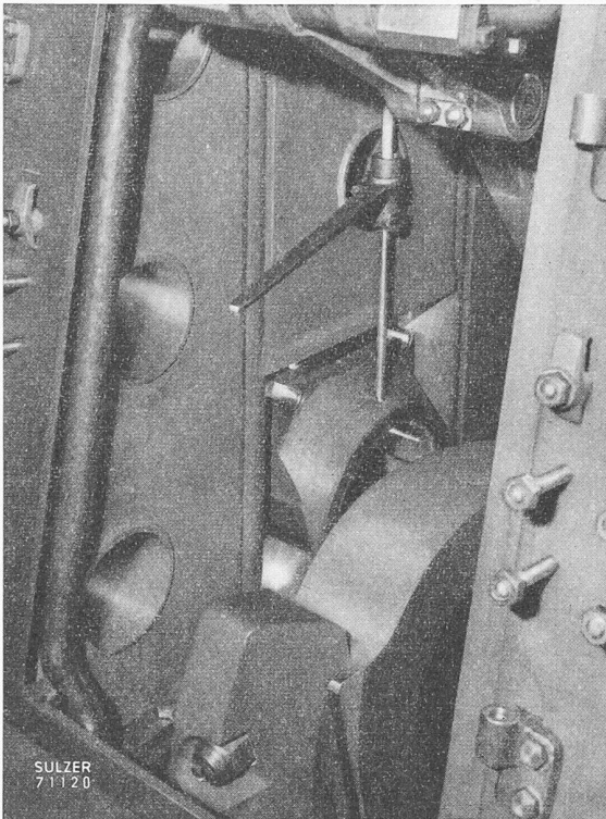
Bild 29. Die Deckel der Kurbelwellenlager können zu Inspektionszwecken mit Hilfe von Gewindestangen emporgelassen und sodann entfernt werden, worauf sich auch die unteren Lagerschalen in üblicher Weise herausnehmen lassen
