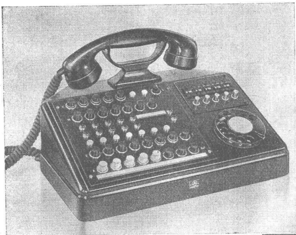
Vermittlungsstation für Telephonanlagen mit 5 Amtsleitungen.
