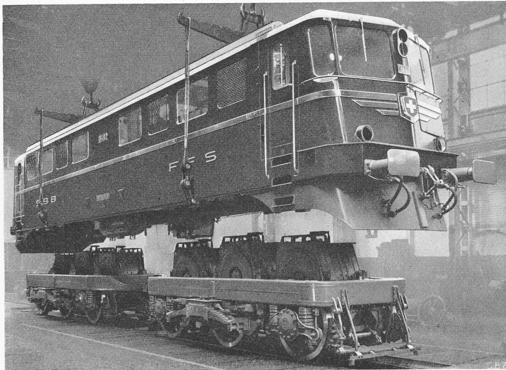
Bild 3. Lokomotivkasten und Drehgestelle
