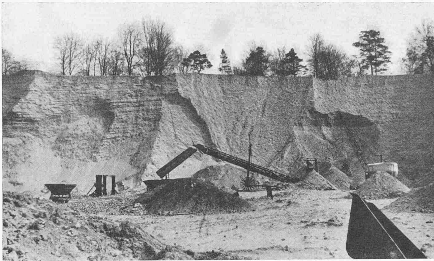
Bild 1. Grube Tilly bei Waterloo. Quarzsand mit rd. 96 % \text{SiO}_2 , Schichthöhe rd. 15 m
