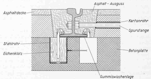
Bild 6. Rasch auswechselbare Strassenbahngleisanlage auf einem Viadukt
