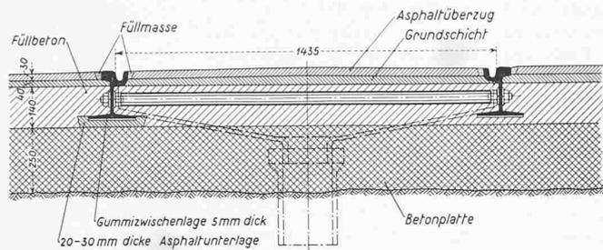
Bild 5. Strassenbahngleisanlage mit Gummizwischenlagen am Schienenunterteil; 1:25
