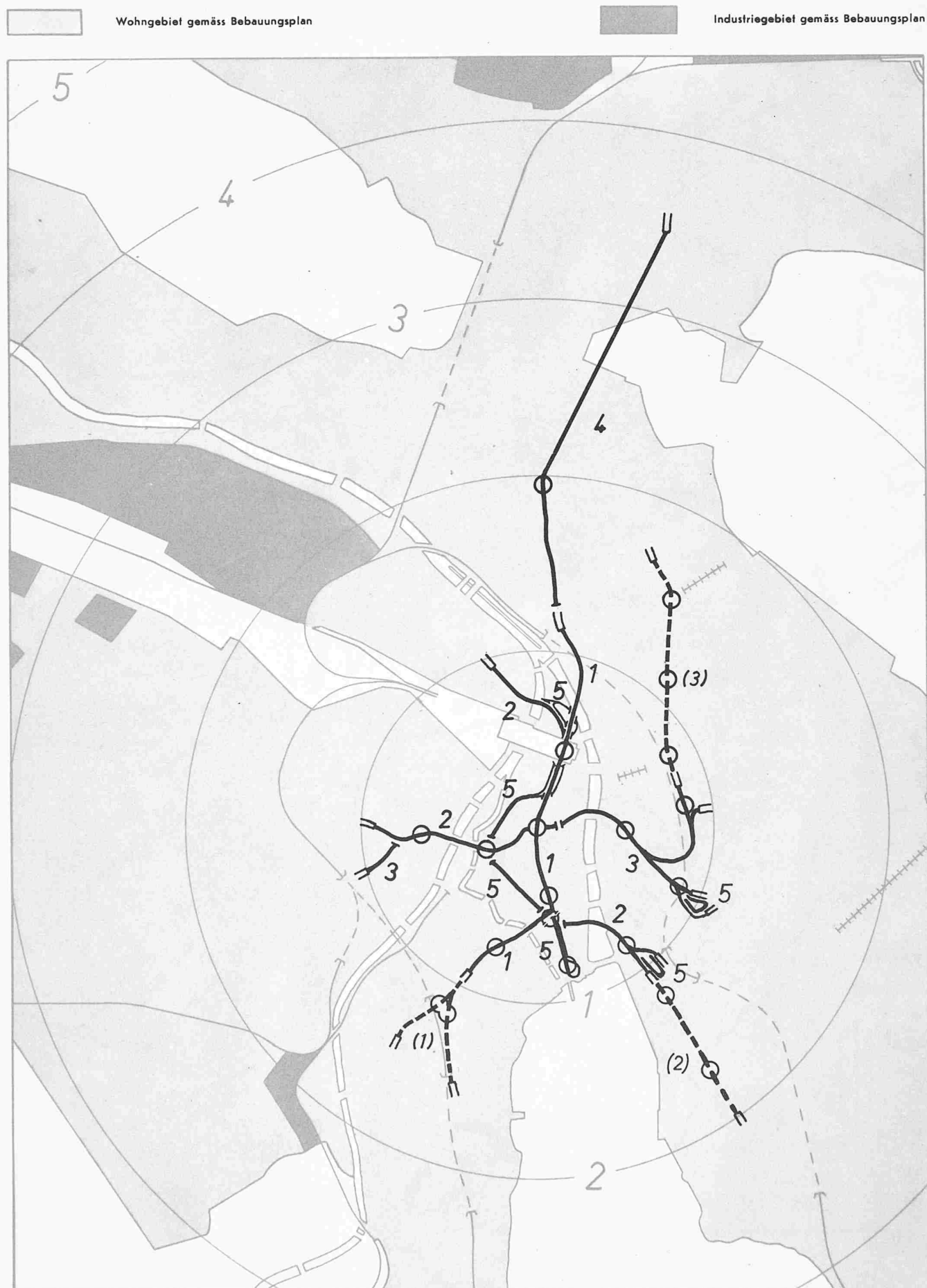
Bild 7. Ausführungsvorschlag für ein unterirdisches Schnell-Strassenbahn-System; Bauperioden
