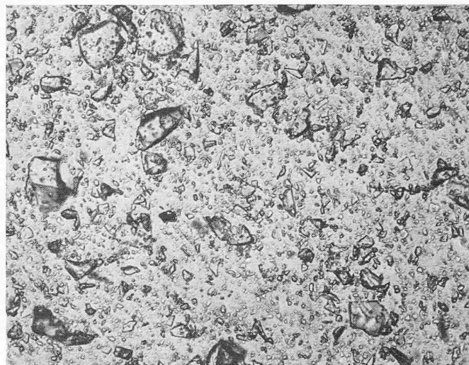
Bild 2. Reine Hochofenschlacke, CH, granuliert und gemahlen, in durchfallendem Licht bei rd. 150facher Vergrösserung
