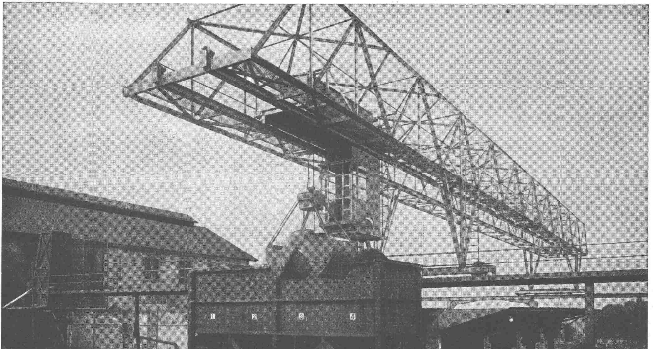
Verladebrücke in Schweisskonstruktion 2,5 t Tragkraft, 46 m Länge
