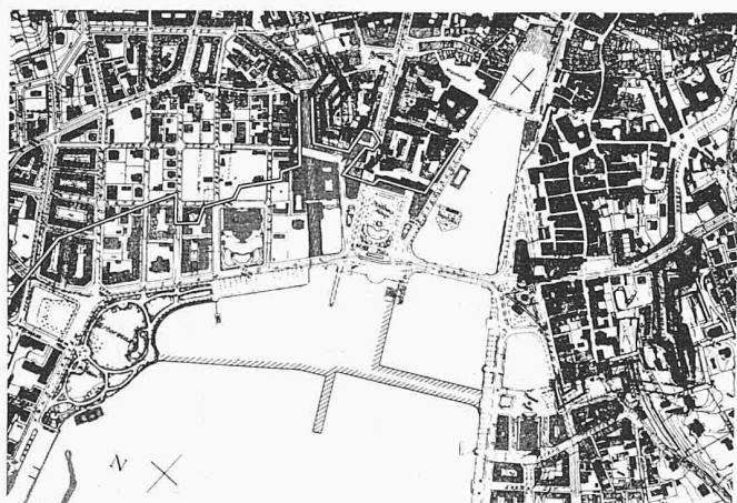
Bild 1. Die Quaianlagen am Nordende des Zürichsees. Der Doppelstrich bezeichnet die Uferlinie vor 1882, als Stadt-Ingenieur Bürkli den Ausbau der Quaianlagen in Angriff nahm. Bis zur Bauvollendung im Jahre 1887 wurde die heutige Uferlinie erreicht, welche einen Landgewinn von 420 000 m 2 brachte. Die anschraffierte Linie gibt den Umriss der Ufer nach Ausführung des Projektes «Seepark» wieder, welches einen neuen Flächengewinn von 70 000 m 2 schaffen würde.
